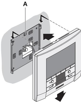
**I** Dopo aver effettuato tutti i collegamenti fissare il Polyx Video Display alla base avendo cura di disporre i fili in modo che non vengano danneggiati.
