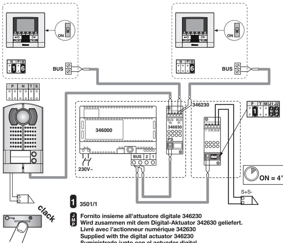
S+S = 18V - 4A impulsivi - 250mA mantenimiento (30 Ohm max)
