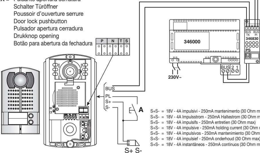
S+S- = 18V - 4A impulsivi - 250mA mantenimiento (30 Ohm max)
