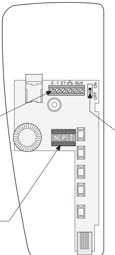
**I** In impianti audio non è necessario selezionare lo switch. In impianti misti audio/video spostare su ON solo nell'ultimo citofono della tratta di ogni appartamento e di ogni montante.
